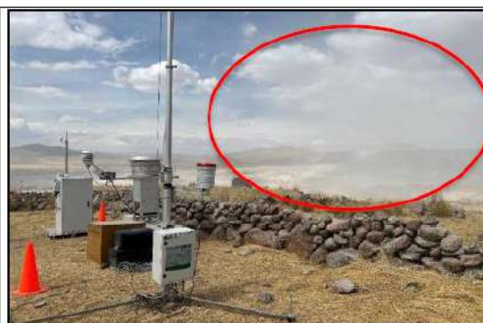
Fotografía N° 6: Estación de monitoreo AIR-06, ubicada en la Comunidad de Alto Huarca - Sector Sol Naciente 2. En el círculo rojo se observa presencia de material particulado después de la operación de voladura en el Tajo Sur, el 23 de setiembre de 2022 a las 14:05 horas.
