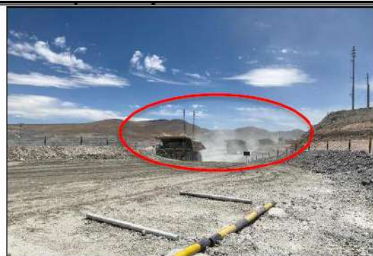
Fotografía N° 11: Tajo Sur de la UF Antapaccay. En el círculo rojo se observa presencia de material particulado por transporte de vehículos dentro del tajo.
