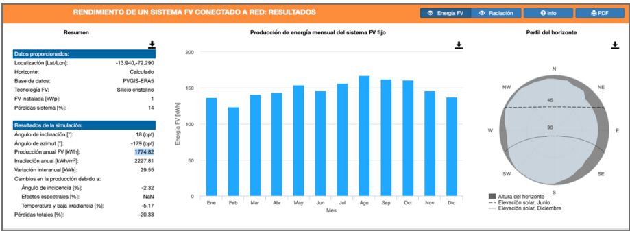
Figura 32. Potencial de generación solar en Paco Paco con sistema de inclinación fija
