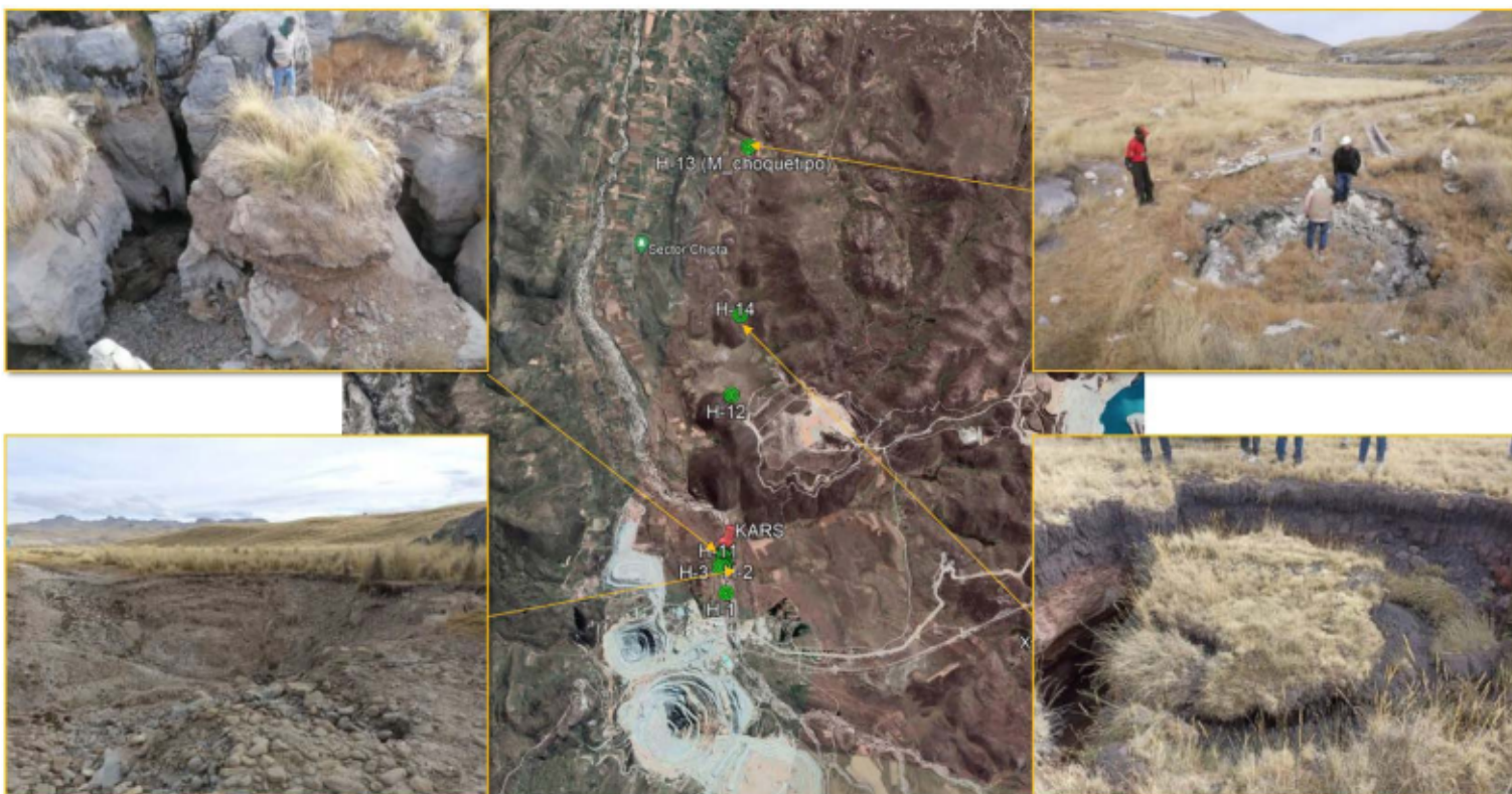
Fotos y ubicaciones de hundimientos identificados aguas abajo de las operaciones de Antapaccay. Fuente: OEFA - Informe N° 00144-2023-OEFA/DEAM-STEC, Anexo 1, p. 234.
